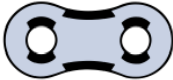
Fig. 1 Emplacements où les fissures risquent de se développer/ Positions where cracks are likely to develop
